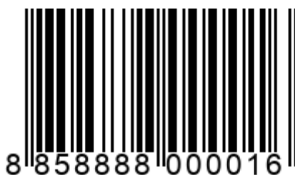
รูปแสดงสัญลักษณ์บาร์โค้ดแบบ 1 มิติ ชนิด EAN-13 (รหัสที่แสดงในสัญลักษณ์ข้างต้นเป็นเพียงตัวอย่างรหัสเท่านั้น)
